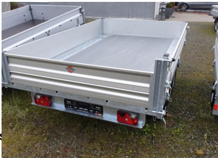
Stema Trius 3-Seitenkipper Alu Bordwand 3500kg
